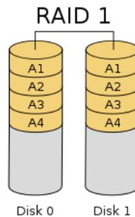
Hier werden alle Daten jeweils auf allen Festplatten gespeichert (gespiegelt). Dieses System bietet eine hohe Ausfallsicherheit, da bei einem Ausfall einer Platte die andere Festplatte immernoch alle Daten bereitstellen kann. Beim lesen der Daten wird die Leistung erhöht (bei 2 Platten doppelte Leseleistung), da parallel von verschiedenen Festplatten Sektoren gelesen werden kann (Geschwindigkeit gleich hoch wie bei RAID 0).
