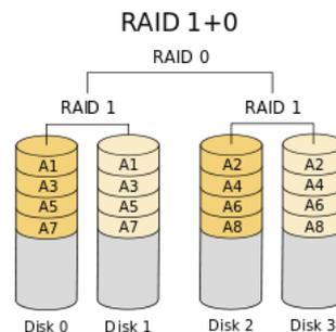
Ist ein RAID 0 Verbund über mehrere RAID 1 Verbünde. Dabei werden Sicherheit und gesteigerte Schreib-/Lesegeschwindigkeiten miteinander kombiniert. Hierbei wird immer eine gerade Anzahl  $\geq 4$  an Festplatten benötigt. Es bietet eine schnellere Rekonstruktion der Daten, da diese im unteren Zweig (RAID 1) wiederhergestellt werden und nicht über den Hauptzweig wie bei RAID 01.
