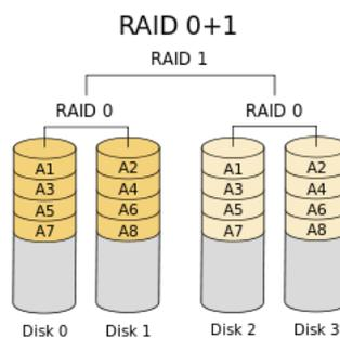
Ist ein RAID 1 Verbund über mehrere RAID 0 Verbünde (01 Leserichtung von unten nach oben). Dieser Verbund kann auch mit einer ungeraden Anzahl an Festplatten erzeugt werden (im Gegensatz zu RAID 10). Dann werden bei bspw. 3 Platten auf jeder 50% Nutzdaten und 50% Spiegelung der Nutzdaten einer anderen Platte eingeteilt. Die Daten werden wie bei RAID 0 gestriped und bei Ausfall müssen in diesem Fall 2 von 3 Platten in Takt sein, um die Daten vollständig wiederherstellen zu können.
