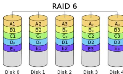
Dieses System verkraftet bis zu 2 gleichzeitig ausfallende Festplatten. Die Wiederherstellung einer Platte dauert viele Stunden in denen RAID 6 im Vergleich zu RAID 5 trotzdem noch vor einem weiteren Ausfall geschützt ist.
