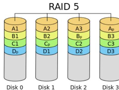
Hier werden die Daten wie bei RAID 0 in Blöcken verteilt auf die Festplatten, jedoch wird dazu immer eine Paritätsinformation erzeugt und auch auf den verschiedenen Platten gespeichert (Unterschied zu RAID 4). Dadurch können die Festplatten sehr Effizient genutzt werden und die Daten sind trotzdem redundant. Der Controller ist jedoch sehr teuer und lohnt sich bei wenigen Platten meistens nicht (RAID 10 günstiger). Die Parität wird durch eine XOR Operation über die Nutzdaten erstellt.
